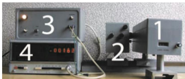
Сурет 1. Сәулелену спектрін зерттеуге арналған қондырғы. 1 – әмбебап шағын монохроматор (МУМ), 2 – сәулені қабылдағыш пен қабылданған сигналды күшейткіш, 3 – күшейткіштің қуаттандыру блогы, 4 – цифрлы вольтметр
