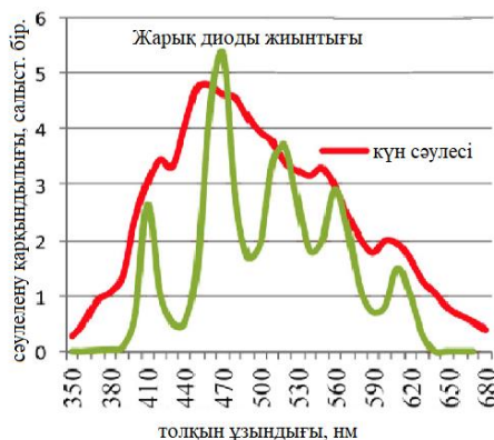
Сурет 4. Күн спектрімен салыстырылған жарық диоды жиынтығы шамының спектрлері
